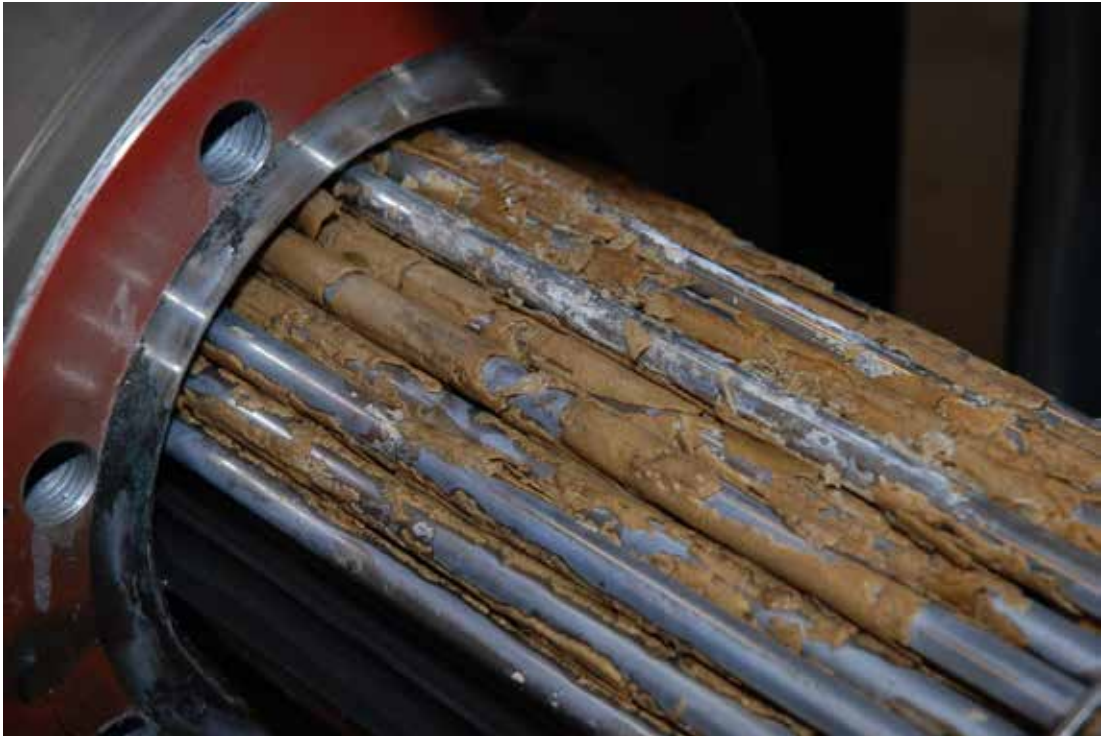
Figur 16: Efter 18 måneders drift har rørbundtet i understation 33/200 en kraftig inkrySTALLISERING af kalkaflejninger på 1-2 mm med et vandforbrug på 642 m 3 uden kalkbeskyttelse. Dette begrænser allerede nu varmeoverførslen betydeligt og reducerer energieffektiviteten drastisk.
