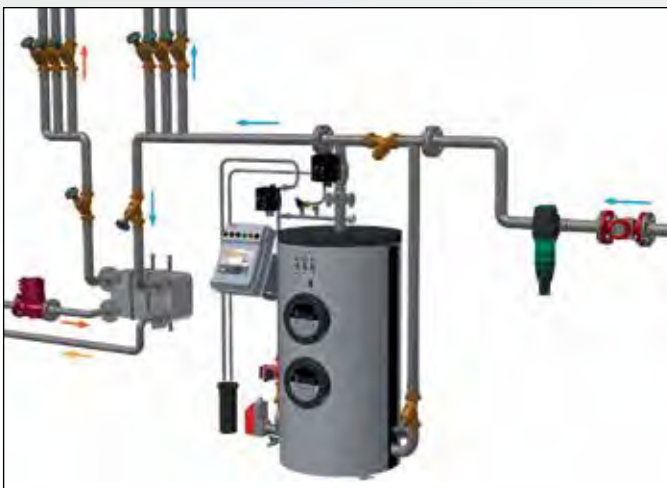
GRAFISK GENGIVELSE af et drikkevandsanlæg med BIOCAT KS 14000 KS 14000
