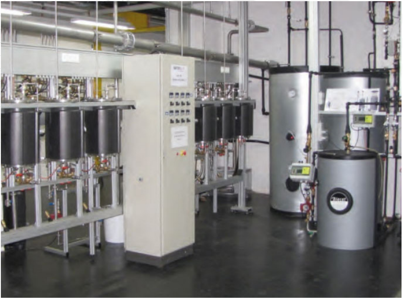
Testfacilitet hos WATERCryst, hvor kalkbeskyttelseseffektivitet testes i henhold til DVGW W 510 som en del af certificeringsprocessen.
